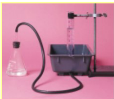
Fig. 4.2. Matja e vëllimit të produktit të gaztë të liruar me kalimin e kohës.
