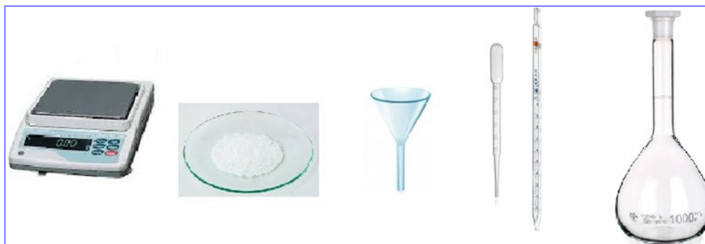
Fig. 2.7. Pajisjet e nevojshme për përgatitjen e tretësirave me përqendrim të caktuar
